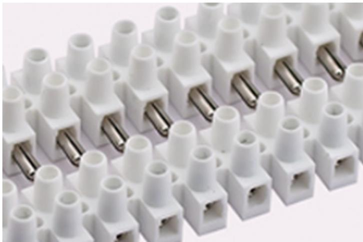
Электроустановочные изделия, предназначенные для соединения проводов. Изделие представляет собой диэлектрический корпус, в котором закреплено несколько металлических контактов с узлами крепления к ним проводов. Контактная часть клеммных колодок изготовлена из латуни и покрыта слоем никеля. Это позволяет получить надежный контакт с высокими токопроводящими свойствами, остающимися неизменными в течение всего срока эксплуатации.
